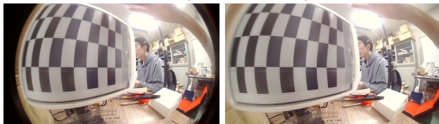
(a) 撮影画像 (b) 補正後画像 図 4: 動的マーカの撮影によるレンズ歪みの補正
